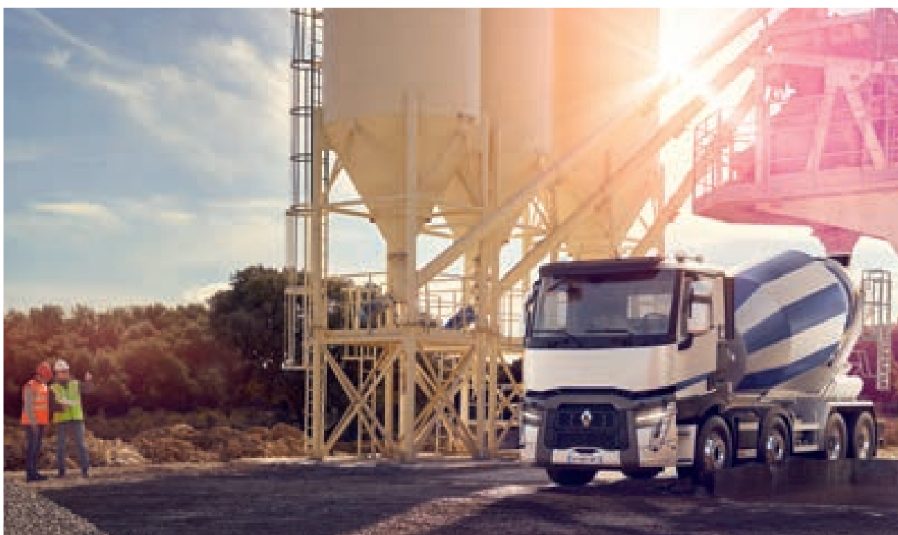
Podvozek C XLOAD 8x4 s domíchávačem betonu: hmotnost na prázdko 9 200 kg.
